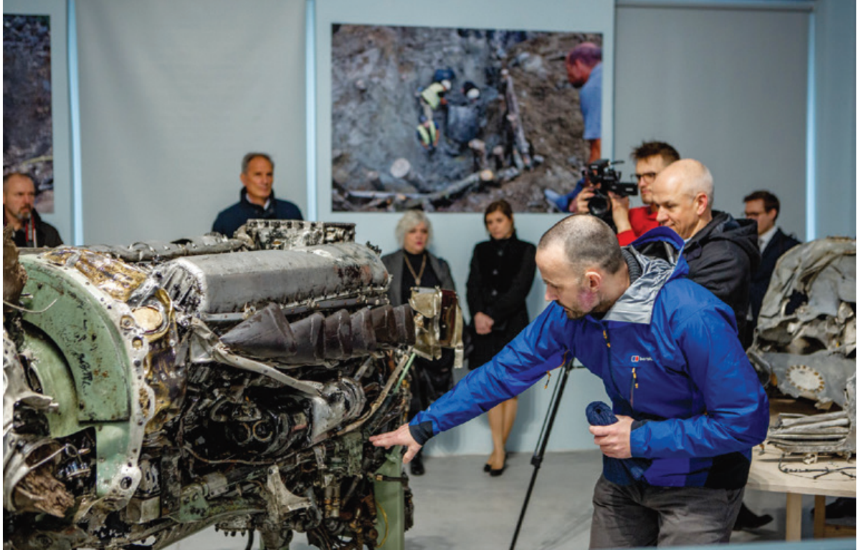
Skoraj 750 kilogramov težak motor znamke Rolls-Royce različice Merlin 63, dvignjen skupaj z ostanki propelerja R.12/4F5/4 znamke Rotol s štirimi lesenimi kraki, je bil javnosti prvič predstavljen na novinarski konferenci v Parku vojaške zgodovine v Pivki, 25. 2. 2020 (foto: S. Avsec)
